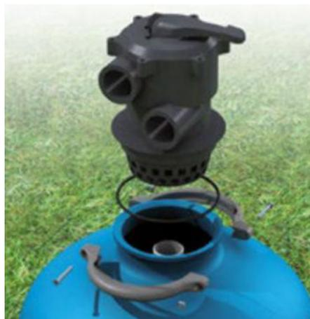
Schrauben Sie das Isolations-Modul (K), die beiden geriffelten Anschlüsse und das Manometer auf das 6-Wege-Ventil. Für alle diese Verschraubungen ist es zwingend erforderlich, Teflon zu verwenden.
