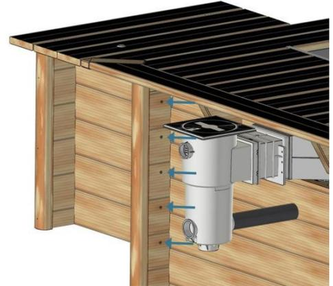
Abb. 63 – Befestigung des Kastens auf dem Becken
