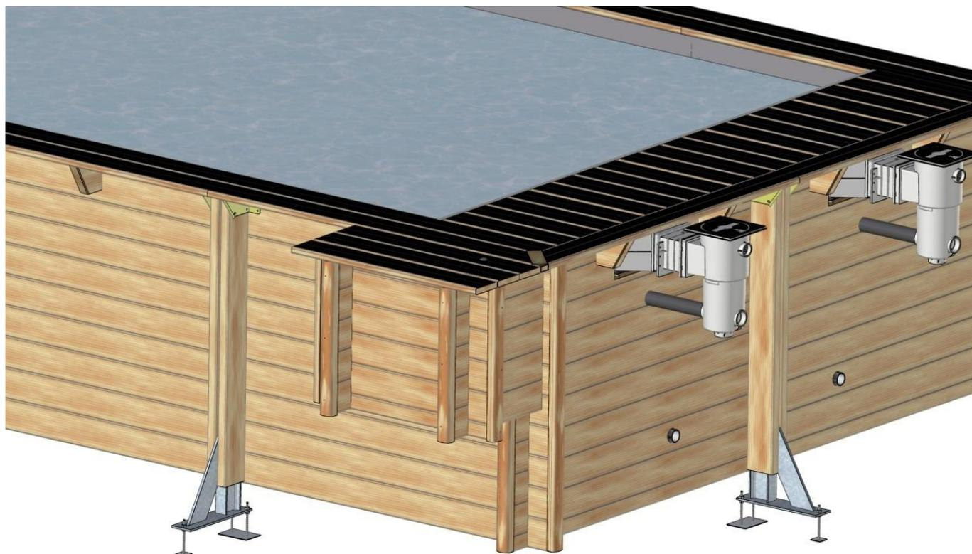
Abb. 57 – Platzierung des Kastens auf dem Becken
