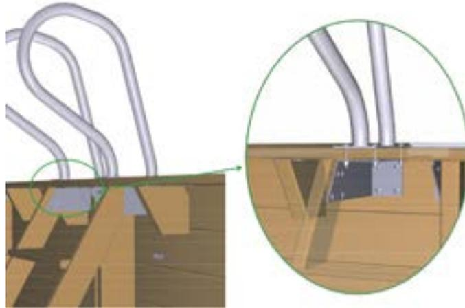
Abbildung 50 – Befestigung der Griffbögen
