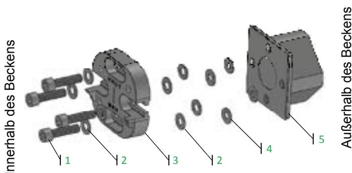
Abbildung 33 – Montage des Flansches mit Lager
