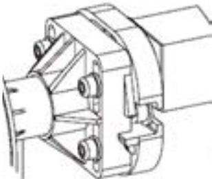
Abbildung 36 – Montage der Achse auf dem Lagerträger
