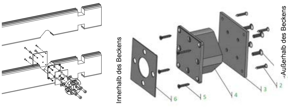
Abbildung 25 – Montage des Lagerträgers
