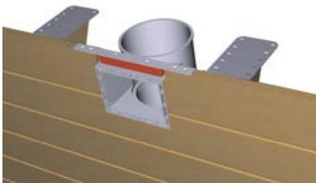
Abbildung 20 – Montage des Winkels am Skimmer
