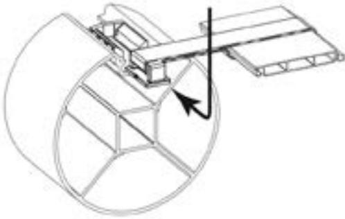
Abbildung 42 – Verbindung von Rollabdeckung und Achse
