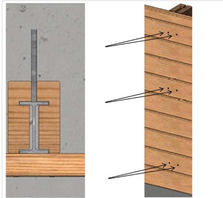
Abbildung 12 – Anbringen der Abschlussprofile auf den Streben
