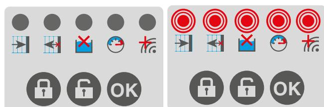
Wenn die 5 LEDs blinken, drücken Sie 1 Sekunde lang die OK-Taste. Beide linke LEDs leuchten.
