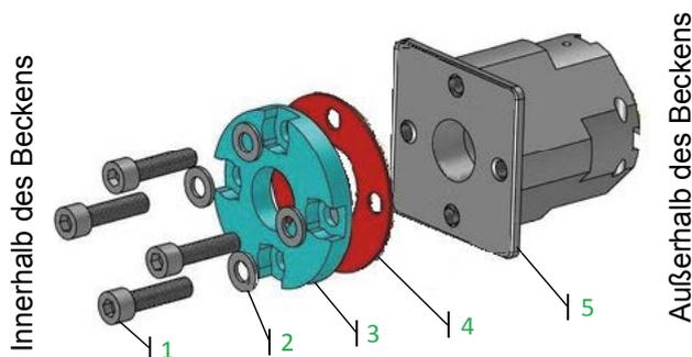
Abbildung 32 – Montage des Flansches für die Wanddurchführung
