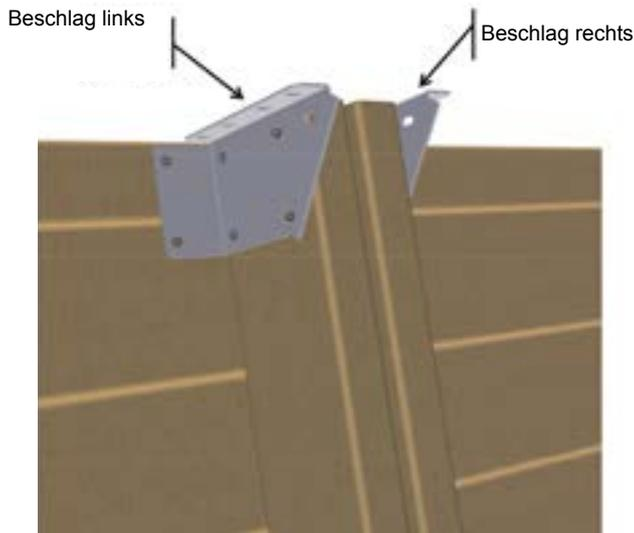
Abbildung 17 – Positionierung der Beschläge am oberen Ende der Streben
