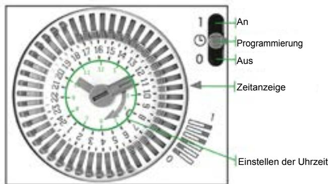
Abbildung 54 – Vorderseite der Uhr der Filteranlage
