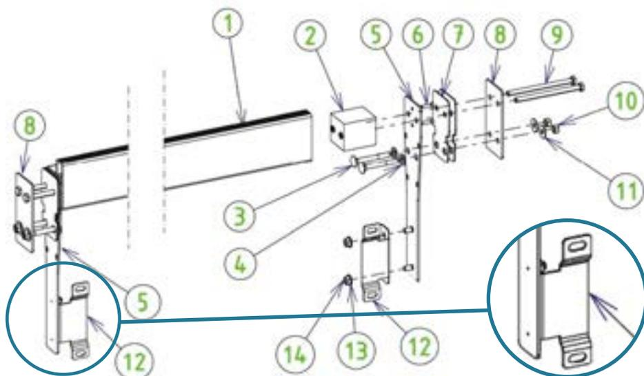
Abbildung 38 – Montage und Installation des Trägers
