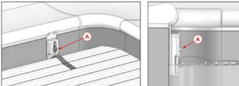
Abbildung 44 – Sperrung und Entsperren der Rollabdeckung
