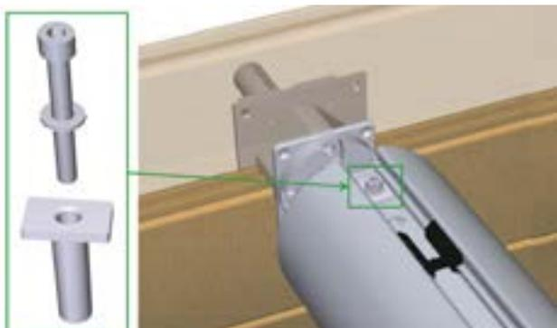
Abbildung 37 – Verriegelung der Welle in der Achse der automatischen Abdeckung
