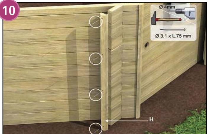
Befestigen Sie die Abschlussprofile (Typ H) an den herausstehenden Ecken jeder Wand; verwenden Sie dazu 4 Edelstahl-Nieten mit gleichem Abstand und stecken Sie diese in die vorgebohrten Löcher in der Achse.
