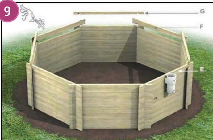
Fügen Sie nun die obere für den Skimmer vorgesehene Bohle (Typ E) in die soeben montierte Bohle (Typ D) und montieren Sie entlang der Poolwand 3 Bohlen des Typs F und 4 halbe Bohlen des Typs G wie in der Abbildung gezeigt.
