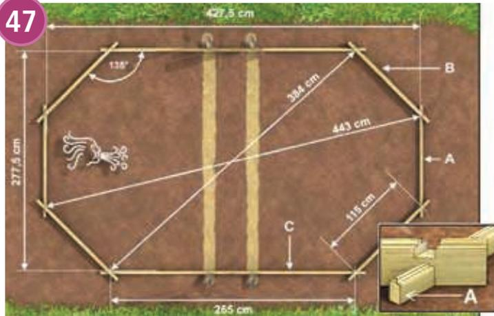
Passen Sie 2 Halb-Bohlen (Typ A), 2 Halb-Bohlen des Typs C sowie 4 Bohlen des Typs B gemäß Abbildung ineinander. Die gefurchte Seite sollte dabei nach oben zeigen (siehe Bildausschnitt).
