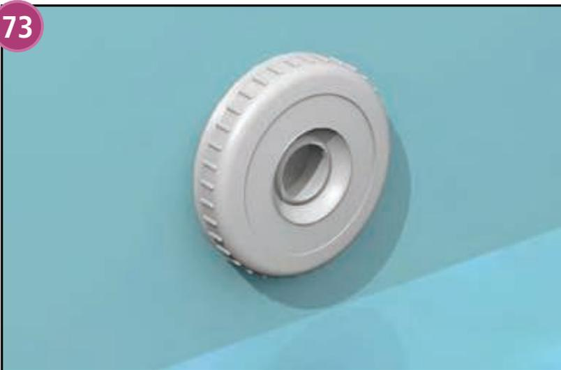
Schrauben Sie die Kugel in das Gehäuse der Einlaufdüse. Die Kugel sollte möglichst nach links gerichtet sein, um den für eine effiziente Filtration erforderlichen Wasserfluss zu erleichtern. (Bei Bedarf können Sie die Kugel und ihr Gehäuse vor der Montage mit Silikon anfetten).
