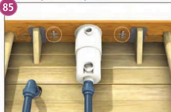
Befestigen Sie nun noch in den 8 Ecken die Verbindungsplatten (Handlauf-Set) wie oben gezeigt; achten Sie dabei darauf, die Platten richtig zu positionieren.
