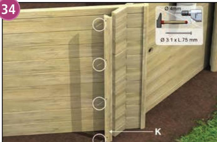
Befestigen Sie ein Abschlussprofil (Typ K) am Ende jeder Wand; verwenden Sie dazu je vier 3,1 x 75 mm Schrauben (Pack L) und schrauben Sie diese in die vorgebohrten - und in regelmäßigen Abständen angeordneten - Löcher entlang der Achse.
