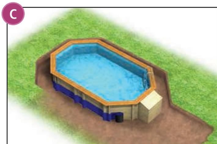
Bauen Sie Ihren Pool wie in der Montageanleitung beschrieben zusammen. Versehen Sie die Poolwände außen mit einer Schutzfolie (Dampfsperren-Folie für Fundamente, nicht im Lieferumfang enthalten) und zwar bis zu der Höhe, wie der Pool im Erdreich eingelassen sein wird.
