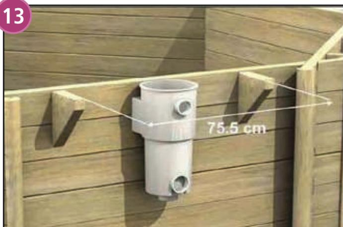
Montieren Sie 2 Holzkeile an der Wand, die den Skimmer beherbergt. Die Keile sollten 75,5 cm voneinander entfernt sein und jeweils den gleichen Abstand zum Skimmer aufweisen.
