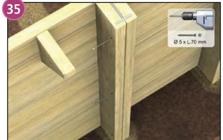
Schrauben Sie die Metallpfosten (vorgebohrt) mit Hilfe von Schrauben aus Pack C von außen an den Holzwänden fest. Achten Sie darauf, dass die Pfosten exakt vertikal verlaufen. Positionieren Sie an beiden Seiten der Pfosten ein Abschlussprofil (Q) und befestigen Sie es mit Hilfe von 3 x 70 Schrauben (Pack C) wie abgebildet.
