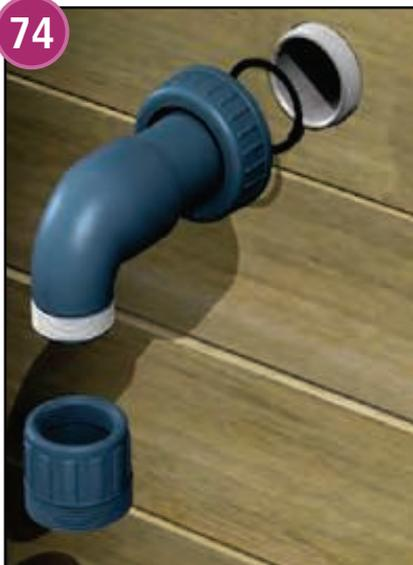
Legen Sie sich die starren abfallenden Rohre C&C aus dem Zubehör-Set bereit und umwickeln Sie das Gewinde der Bögen 4 bis 5 mal mit Klebeband. Schrauben Sie die Rohre dann an die Außenseite der Wanddurchführungen (Einlaufdüse und Reinigeranschluss). Vergessen Sie dabei die O-Ringe aus dem Einbauteile-Set nicht. Ziehen Sie die Schrauben von Hand an, um die Dichtung nicht zu beschädigen. Schrauben Sie dann die Halbverschraubung des starren abfallenden Rohres C auf das Gewinde.
