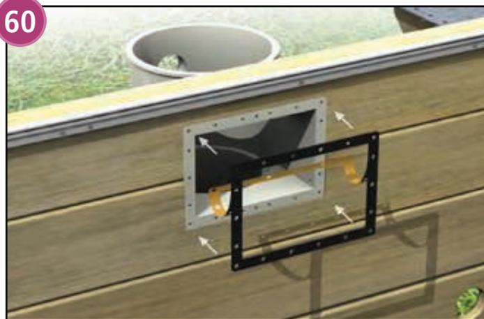
Bevor Sie mit dem Einpassen der Folie beginnen, muss einer der beiden rechteckigen selbstklebenden Dichtungen (Einbauteile-Set) an die Skimmer-Öffnung geklebt werden.
