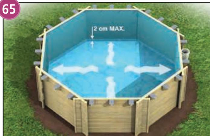
Sobald die Folie eingehängt und korrekt positioniert wurde, befüllen Sie das Becken mit 2 cm an Wasser. Schieben Sie etwaige Bodenfalten in Wandrichtung weg und glätten Sie dadurch die Folie so gut wie möglich.
