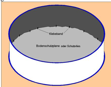
Achtung: bei Verwendung von Styropor als Isolierung, muss dieses mittels Vlies von der Innenhülle getrennt werden, da Styropor der Innenhülle die Weichmacher entziehen würde.
