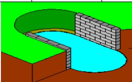
Mit geeignetem Kleber 20 mm starke Styrodurplatten, oder andere fürs Erdreich geeignete Isolierplatten, an den Innenseiten der Stützmauern anbringen; dabei oberhalb der Bodenplatte, ca. 25 mm für die Bodenschienen frei lassen.
