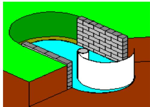
**Achtung:** Der vorgestanzte Skimmerausschnitt befindet sich ca. 200 cm vom äußeren Wandende entfernt. Achten Sie darauf, daß beim Einsetzen der Stahlwand sich der Skimmerausschnitt auch am gewünschten, richtigen Ort befindet. Bei Schwimmbecken mit 2 Stahlwänden befindet sich der Skimmerausschnitt in der Wand 1.
